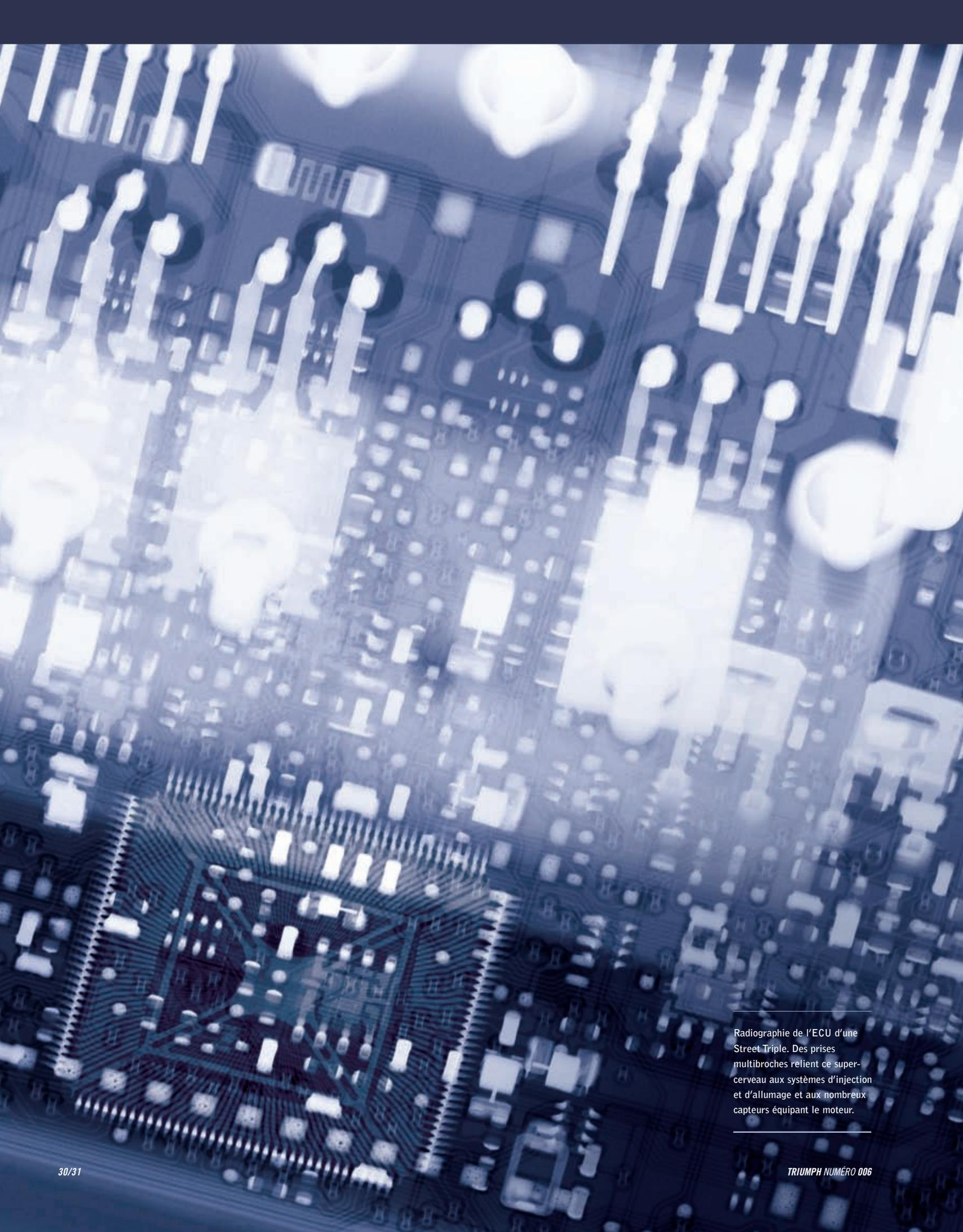
Radiographie de l'ECU d'une Street Triple. Des prises multibroches relient ce super-cerveau aux systèmes d'injection et d'allumage et aux nombreux capteurs équipant le moteur.
